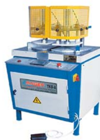
ТКВ-А Одноголовочный сварочный станок для ПВХ-профиля
