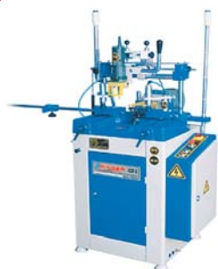
KDF-S Универсальный копировально-фрезерный станок (трехшпиндельная голова + 2 фрезы)
