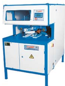
КТ (2 фрезы), КТ-А (4 фрезы). Автоматический углозащитный станок
