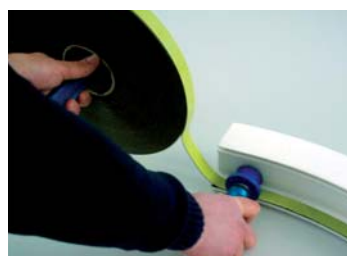
Нанесение клейкой ленты STV® при изготовлении нестандартных конструкций
