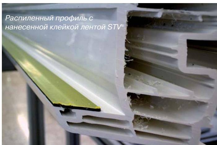
Сварка профиля с нанесенной клейкой лентой STV®
