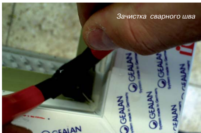
Сварка профиля с нанесенной клейкой лентой STV®
