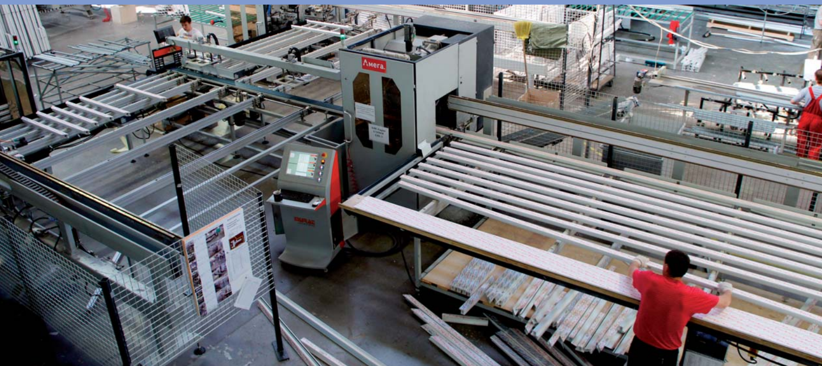
Производство на оборудовании Murat. На переднем плане обрабатывающий центр NR-241
