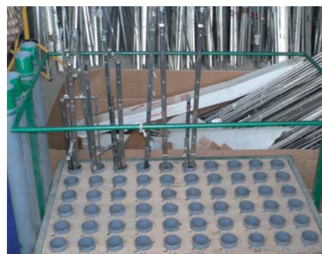
Тележка с пронумерованными ячейками для фурнитуры
