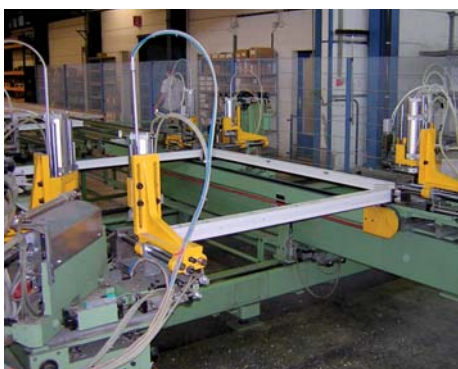
Сварка рамы с установленными ответными планками
