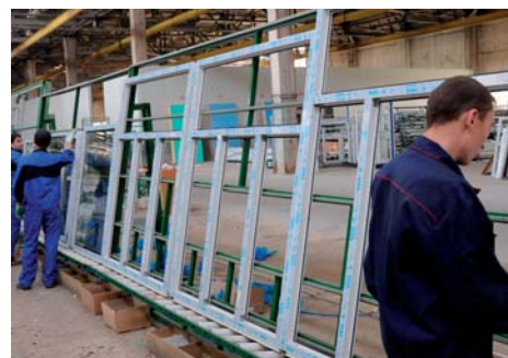
Удлиненный стенд остекления, позволяющий организовать пооперационный конвейер при остеклении
