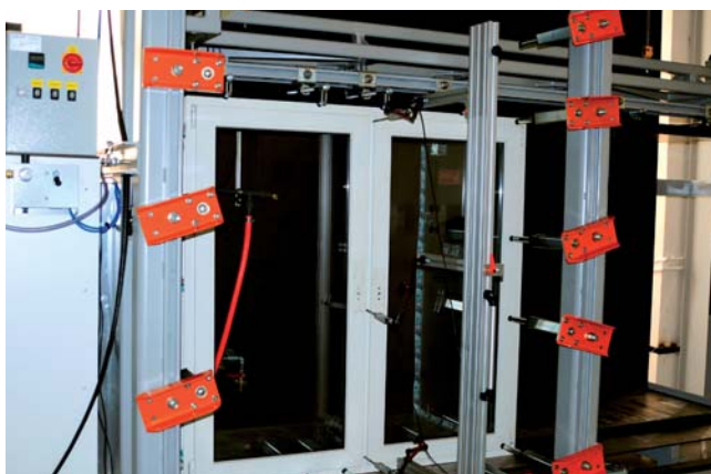
Испытание на сопротивление ветровой нагрузке
