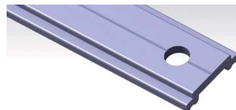
Пробивка отверстий в тяге
