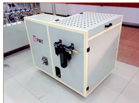
Ящичный плавильник PMT 100-5 с системой осушки воздуха
