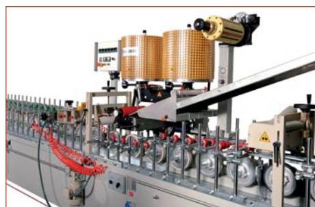
Станок с возможностью использования EVA и PUR для шпона и пленки
