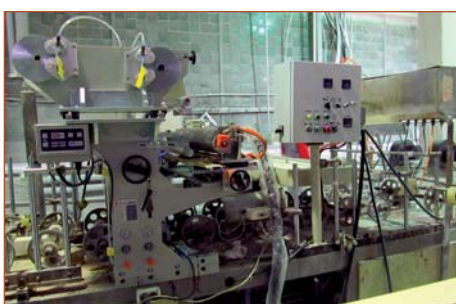
Китайский ламинационный станок с шириной ламинации до 900 мм, переделанный под ПУР-систему
