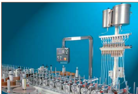
Система автоматизированной подачи праймера на станке
