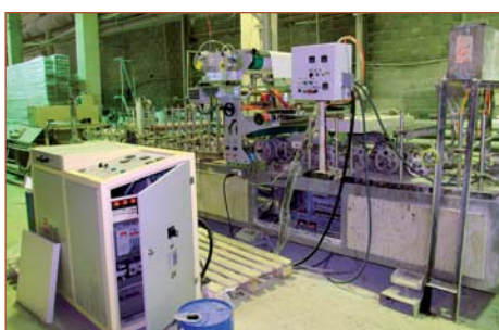
Китайский ламинационный станок с шириной ламинации до 900 мм, переделанный под ПУР-систему
