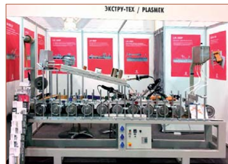
Мини-станок для ламинации. Скорость ламинирования до 12 м/мин
