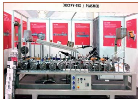
Мини-станок для ламинации. Скорость ламинирования до 12 м/мин
