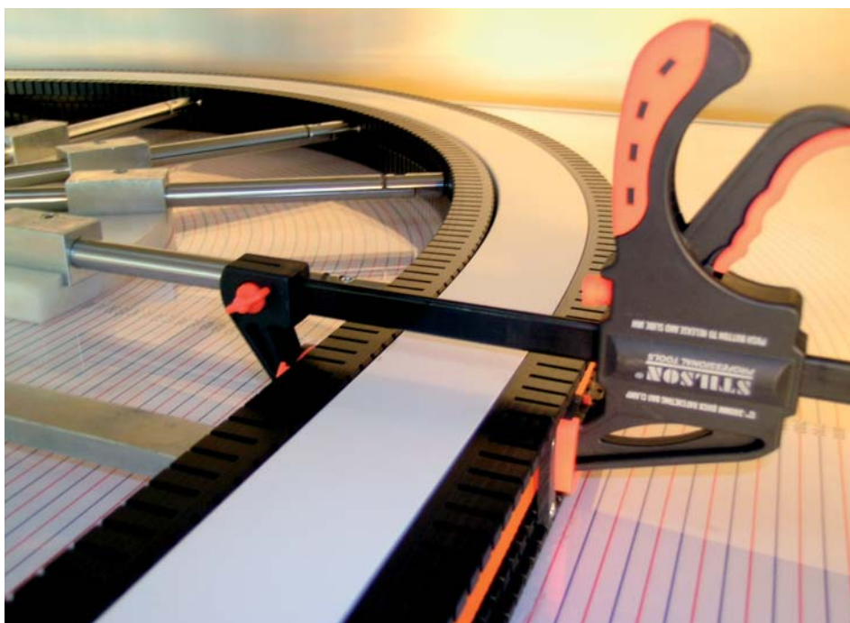
Гибочный стол из комплекта оборудования HABM 6000, INTERGRUP/PLASMEK
