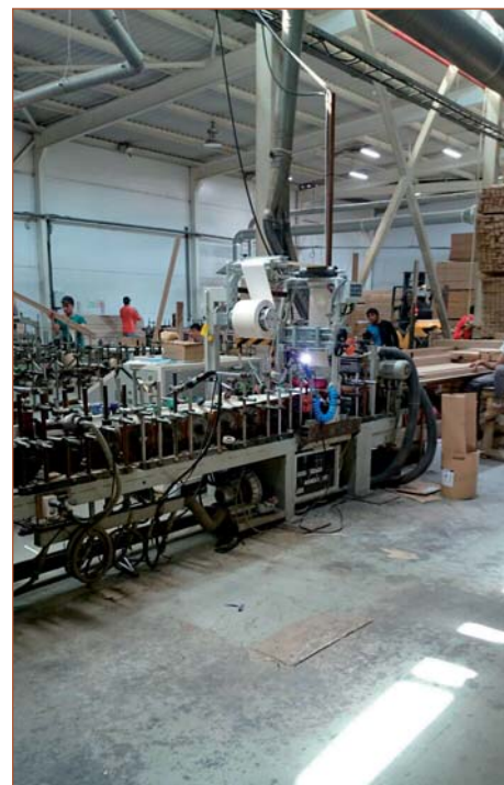
Переоборудование компанией «Экстру-Тех» ламинатора китайского производства на ПУР-систему
