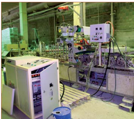
Китайский ламинационный станок с шириной ламинации до 900 мм, переделанный компанией «Экстру-Тех» под ПУР-систему
