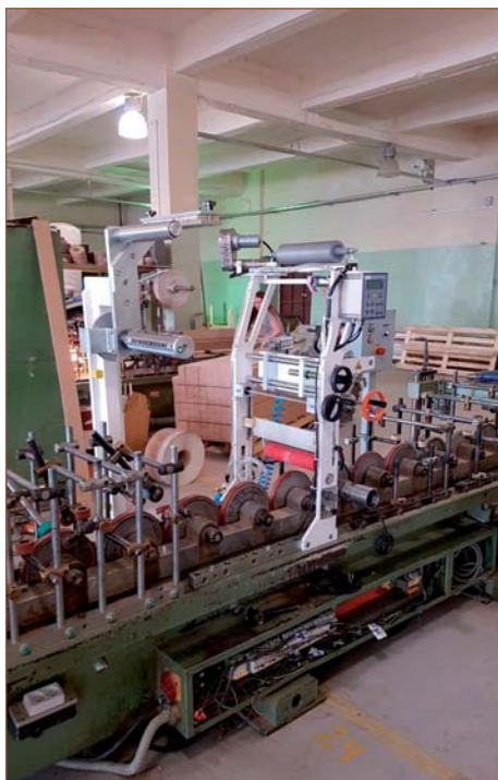
Переоборудование компанией «Экстру-Тех» ламинатора FRIZ на ПУР-систему
