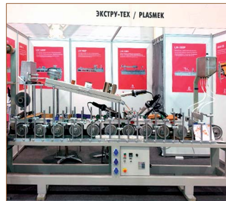
Мини-станок для ламинации. Скорость ламинирования до 12 м/мин
