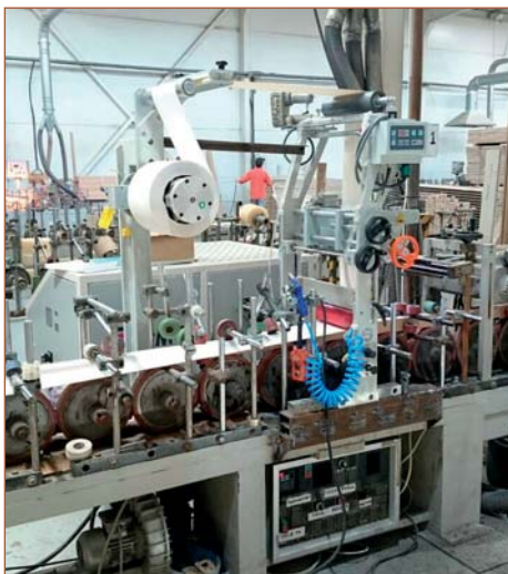
Переоборудование компанией «Экстру-Тех» ламинатора китайского производства на ПУР-систему
