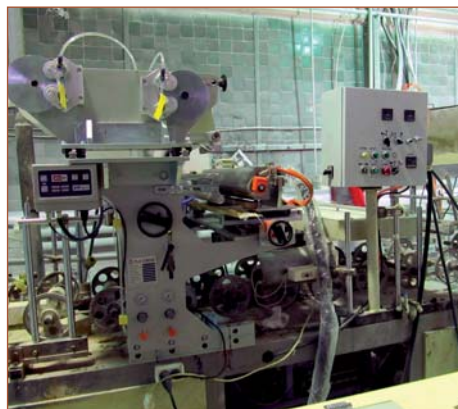
Китайский ламинационный станок с шириной ламинации до 900 мм, переделанный компанией «Экстру-Тех» под ПУР-систему
