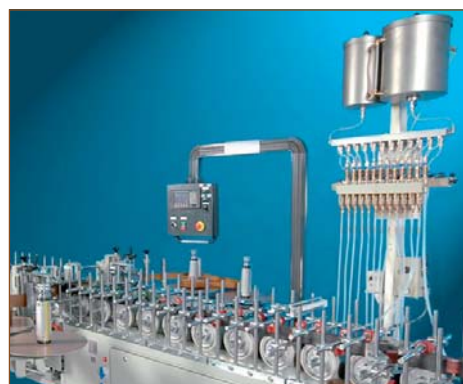
Система автоматизированной подачи праймера на станке
