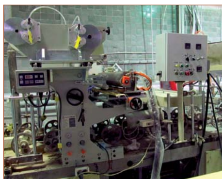
Китайский ламинационный станок с шириной ламинации до 900 мм, переделанный компанией «Экстру-Тех» под ПУР-систему
