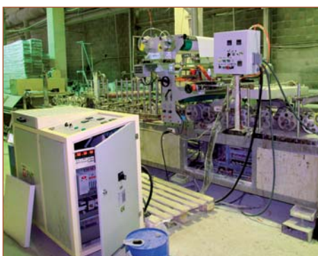
Китайский ламинационный станок с шириной ламинации до 900 мм, переделанный компанией «Экстру-Тех» под ПУР-систему
