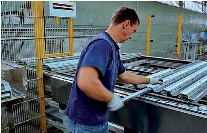
Установка армирования в оконный профиль на производстве
