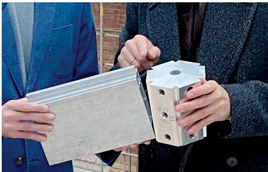
При создании кровли использовался особый алюминий-магний-кремниевый сплав АД35Т1, отличающийся высокой прочностью
