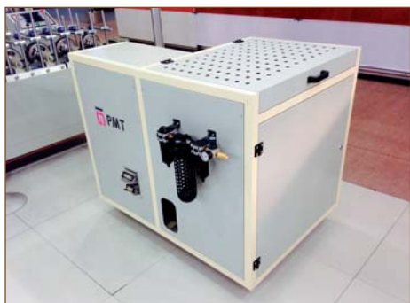
Ящичный плавильник PMT 100 с системой осушки воздуха
