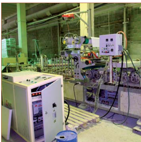
Китайский ламинаторный станок с шириной ламинации до 900 мм, переделанный компанией «Экстру-Тех» под ПУР-систему
