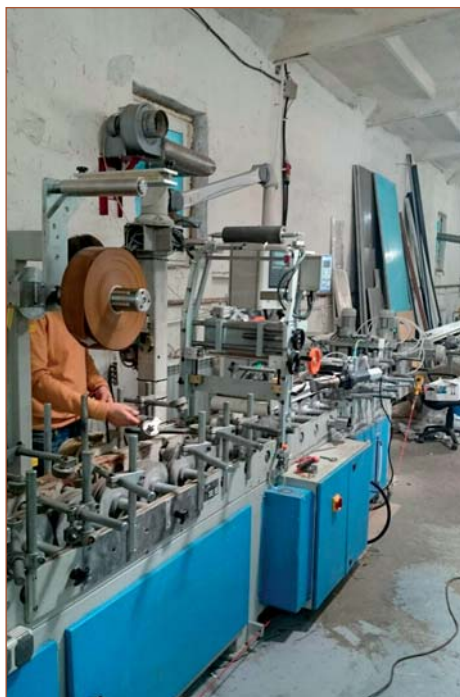
Переоборудование компанией «Экстру-Тех» ламинатора FUX на ПУР-систему
