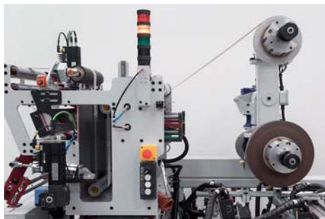
Barberan также предлагает различные решения для повышения производительности: системы быстрой смены инструмента, с помощью которых можно значительно сократить время наладки станка, двойной размотчик с автоматическим сращиванием для непрерывного производства или сис-
