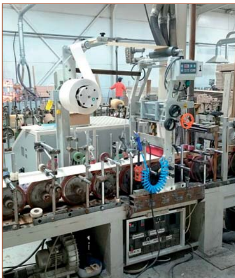
Переоборудование компанией «Экстру-Тех» ламинатора китайского производства на ПУР-систему
