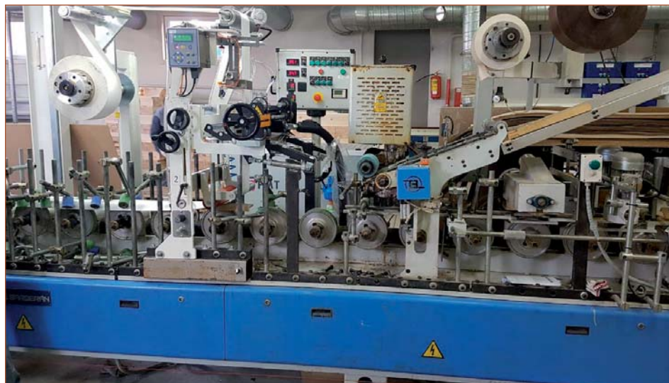
Переоборудование компанией «Экстру-Тех» ламинатора Barberan на ПУР-систему
