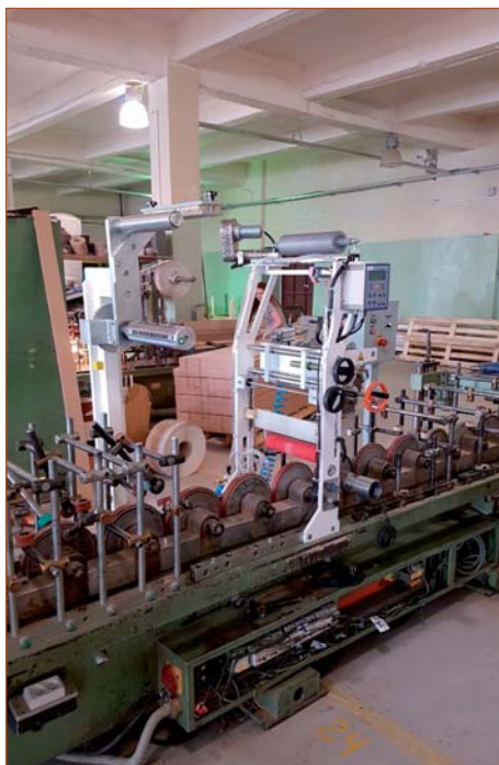
Переоборудование компанией «Экстру-Тех» ламинатора FRIZ на ПУР-систему
