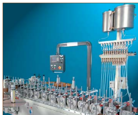
Система автоматизированной подачи праймера на станке
