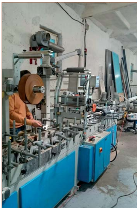
Переоборудование компанией «Экстру-Тех» ламинатора FUX на ПУР-систему
