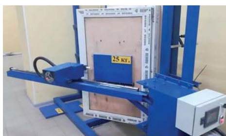
Проверка окна с фурнитурой UPT на испытательном стенде
