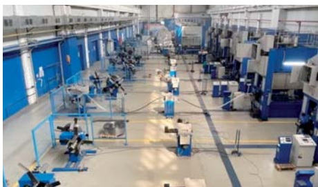
Участок штамповки заготовок для фурнитуры с помощью прессов на заводе «ЮПТ»
