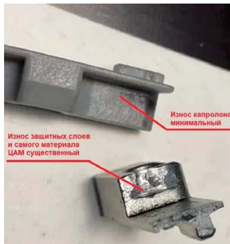
Сравнение износа капролонового зацепа фурнитуры UPT и поворотной откидной планки из ЦАМ
