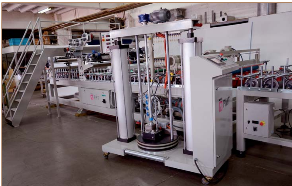
Ламинационный станок на клее-расплаве (бочковой плавильник под 200 кг фасовку клея) для профилей шириной до 1000 мм
