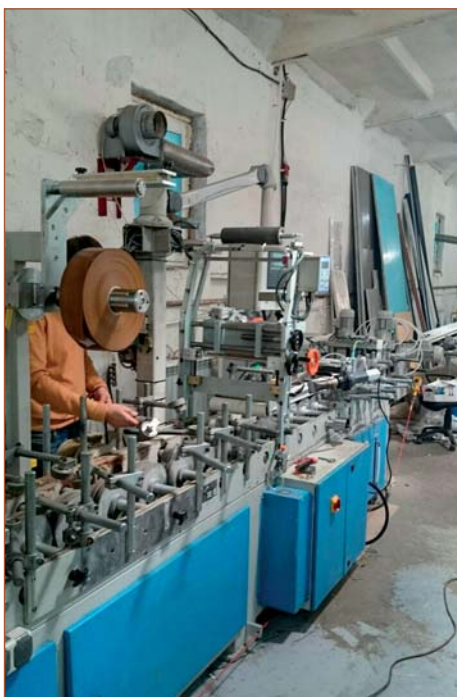
Переоборудование компанией «Экстру-Тех» ламинатора FUX на ПУР-систему
