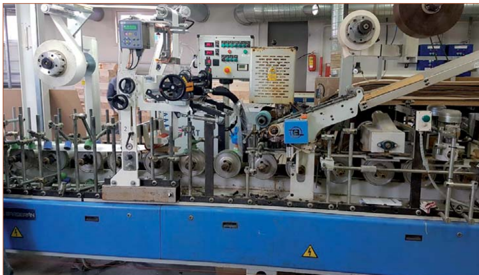
Переоборудование компанией «Экстру-Тех» ламинатора Barberan на ПУР-систему
