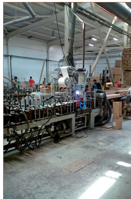
Переоборудование компанией «Экстру-Тех» ламинатора китайского производства на ПУР-систему
