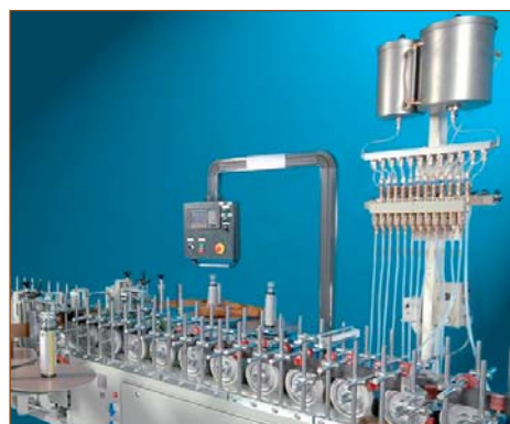
Система автоматизированной подачи праймера на станке
