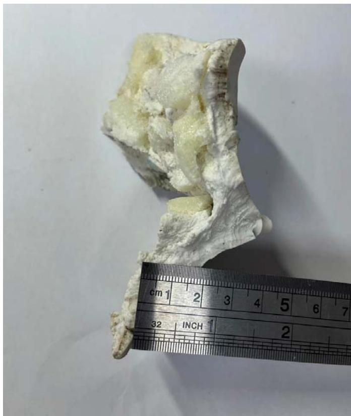
Рис. 2. Измерение слоя герметика
