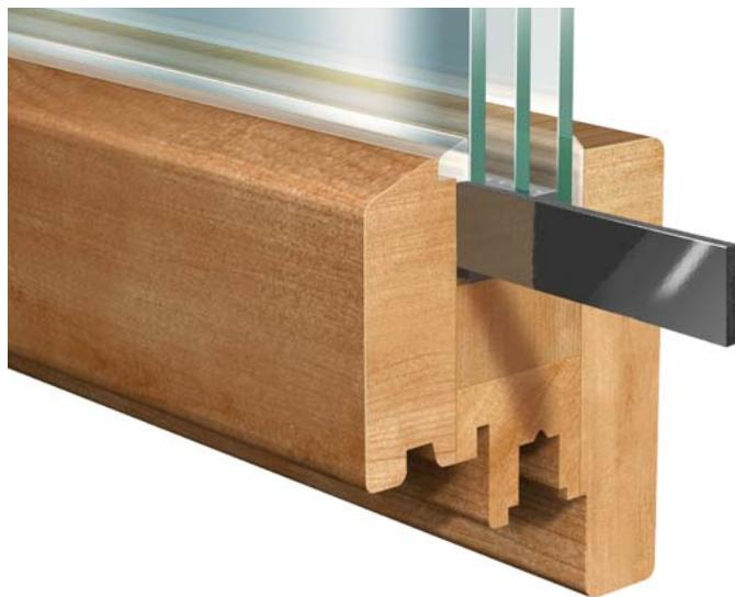
**В** основе SDG заключена технология изолирующей вклейки стекла, где стеклопакет вклеивают непосредственно в оконную раму с помощью высококачественной адгезивной ленты.
