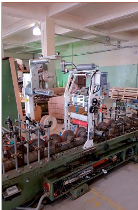
Переоборудование компанией «Экстру-Тех» ламинатора FRIZ на ПУР-систему
