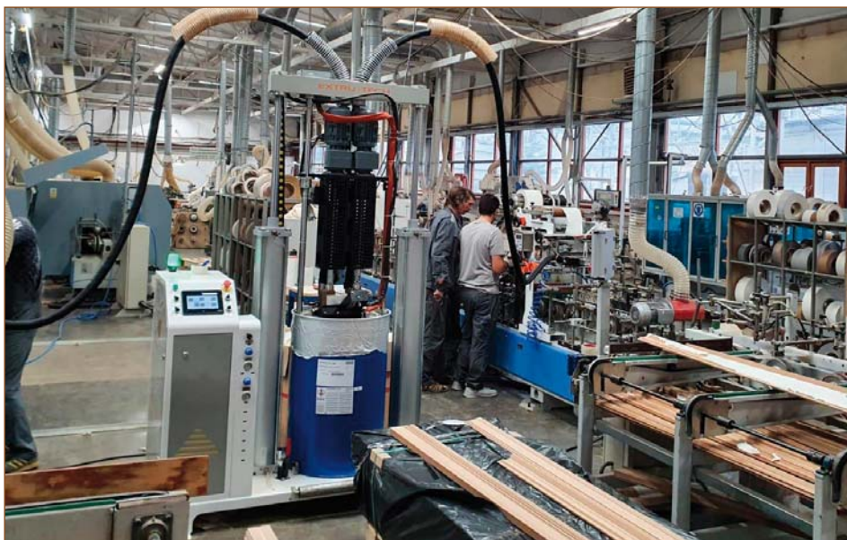
Бочковой плавильник на 200 кг клея под два шланга и два станка
