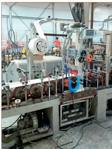
Переоборудование компанией «Экстру-Тех» ламинатора китайского производства на ПУР-систему
