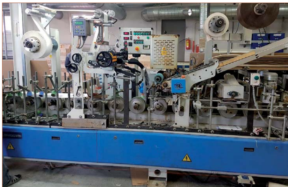
Переоборудование компанией «Экстру-Тех» ламинатора Barberan на ПУР-систему
