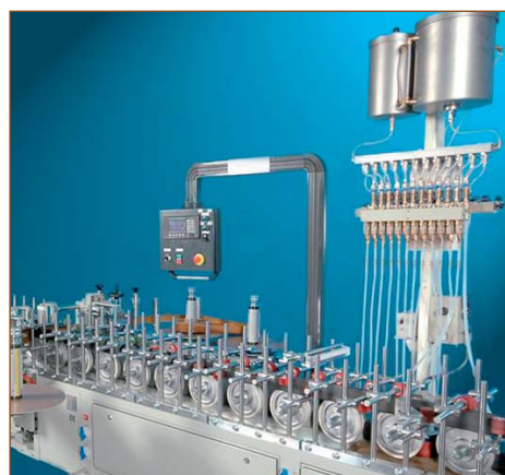
Система автоматизированной подачи праймера на станке
