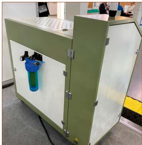
Ящичный плавильник с системой осушки воздуха
