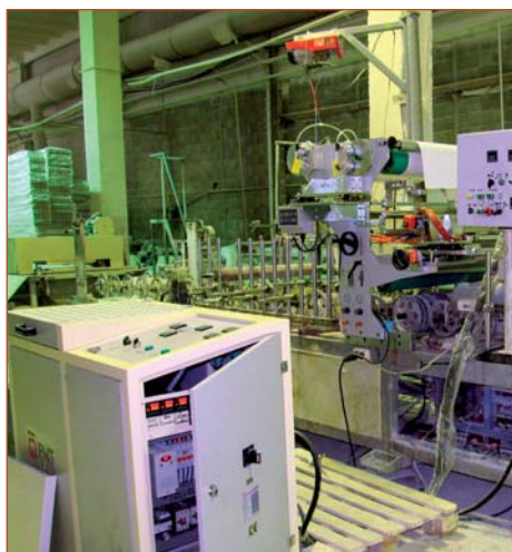
Китайский ламинаторный станок с шириной ламинации до 900 мм, переделанный компанией «Экстру-Тех» под ПУР-систему
