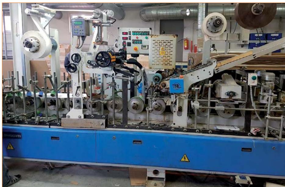
Переоборудование компанией «Экстру-Тех» ламинатора Barberan на ПУР-систему
