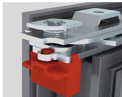
■ В дополнение к привычному переходнику «ручка-тяга» был разработан врезной редуктор с максимально надежной фиксацией в паз профиля. Дополнительную жесткость креплению ручки придают выдвигающиеся плавающие суппорты в местах соединения винтами.
