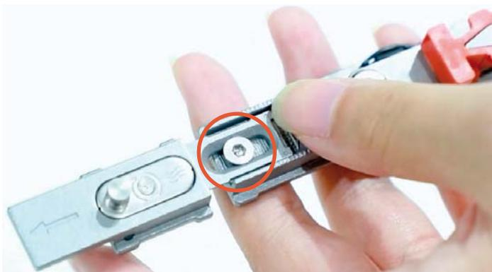
■ Добавлен смарт-переключатель на зимний режим. Теперь пользователю не приходится искать необходимый угол открывания с помощью ручки. Достаточно повернуть смарт-переключатель в положение «зима» или «лето», после чего поворот ручки автоматически откроет окно на соответствующий угол.
