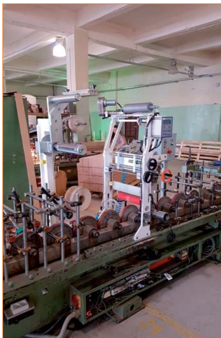
Переоборудование компанией «Экстру-Тех» ламинатора FRIZ на ПУР-систему
