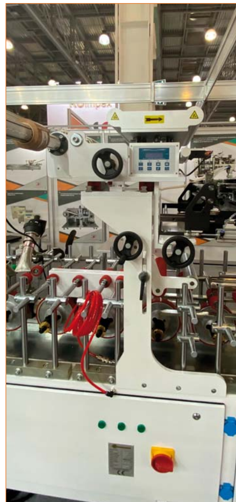
Ламинационный станок для ПВХ- и алюминиевых профилей, работающий на ПУР-клее-расплаве
