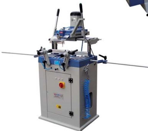
Копировально-фрезерный станок GALAXY-1 с системой охлаждения
